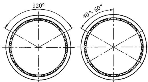
*a* - для труб DN/OD 110 - 160 мм; *б* - для труб DN/OD 200 - 630 мм и DN/ID 200 - 600 мм
