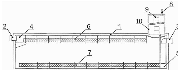
1 - корпус; 2 - подводящий патрубок; 3 - отводящий патрубок; 4 - приемная камера неочищенных стоков; 5 - приемная камера очищенных стоков; 6 - труба распределения потока; 7 - приемные трубы очищенных стоков; 8 - вентиляционная труба; 9 - лестница; 10 - шахта обслуживания
