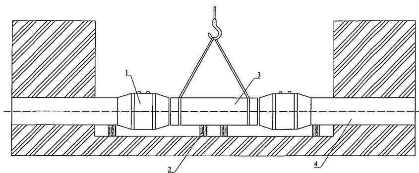
1 - муфта; 2 - опора; 3 - трубная вставка; 4 - трубопровод
