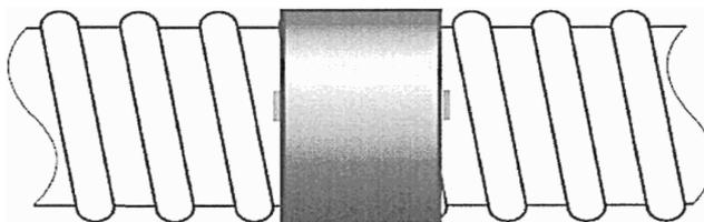
**Рисунок 6.2 - Установка ТУМ на соединении по меткам**
