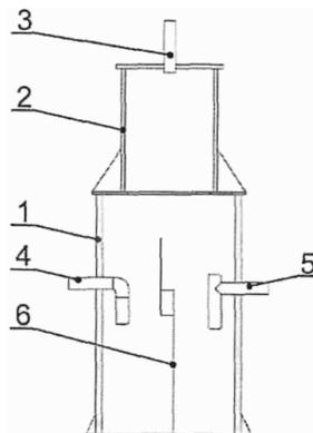
1 - корпус; 2 - шахта обслуживания; 3 - вентиляционная труба; 4 - подводящий патрубок; 5 - отводящий патрубок; 6 - перегородка
