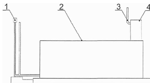
1 - пожарный гидрант; 2 - корпус; 3 - труба вентиляционная; 4 - шахта обслуживания
