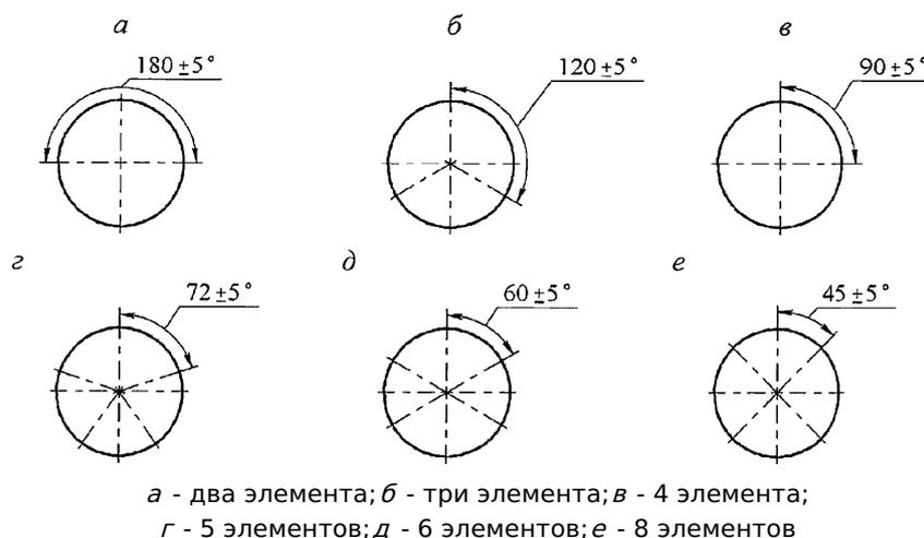
**Рисунок 5.25 - Варианты расположения наварных элементов по периметру опоры**
