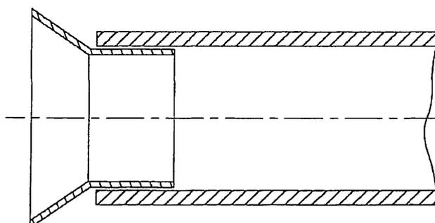
а - защита с помощью отрезков полиэтиленовых труб малого диаметра; б - защита с помощью специальных втулок (вставок)
