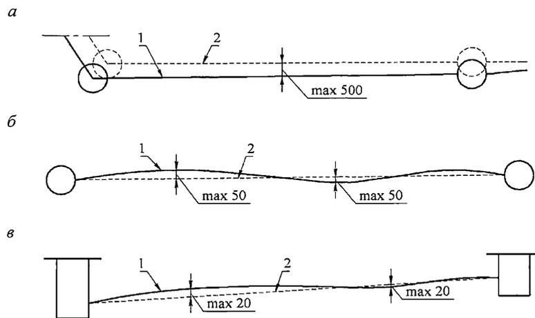
*а* - отклонение проектной трассы от фактической при изменении проектного положения колодцев; *б* - боковое отклонение трассы при сохранении проектного положения колодцев; *в* - отклонение трассы в вертикальном положении;
