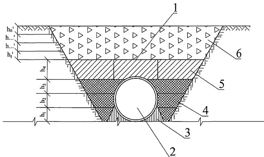
1 - защитный слой грунта (уплотнение допускается проводить только ручным немеханизированным инструментом);
