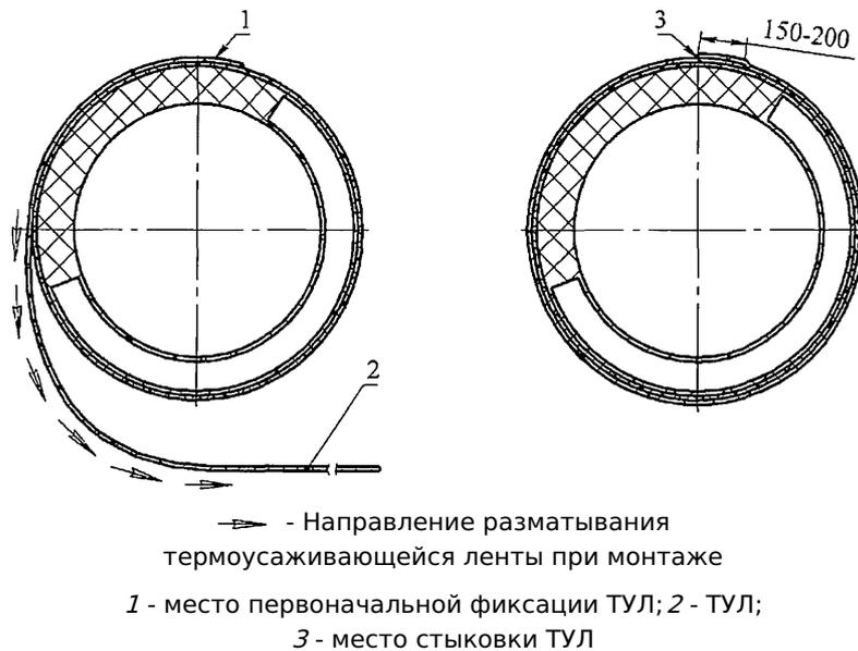
**Рисунок 6.4 - Схема монтажа ТУЛ на место соединения труб**
