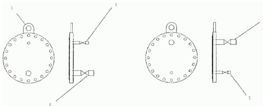
1 - монтажная петля; 2 - клапан и патрубок для подключения шланга для наполнения/опорожнения трубы  $D = 50$  мм;
