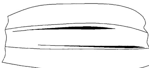
**Рисунок И.6 - Часть сварочного шва с трещинами**
