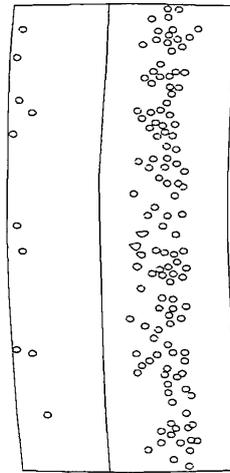
**Рисунок И.2 - Протяженные поры**
