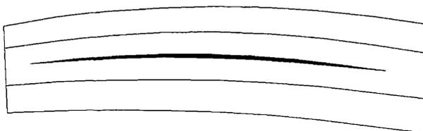
**Рисунок И.4 - Часть сварочного шва с несплавлением**
