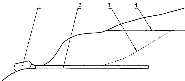
1 - установка ГНБ; 2 - фильтр (с последующим введением дрен); 3 - планируемый уровень грунтовых вод;
