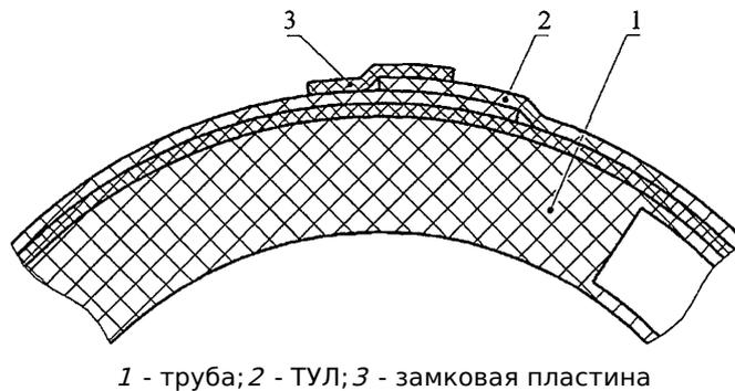
**Рисунок 6.5 - Схема крепления замковой пластины**
