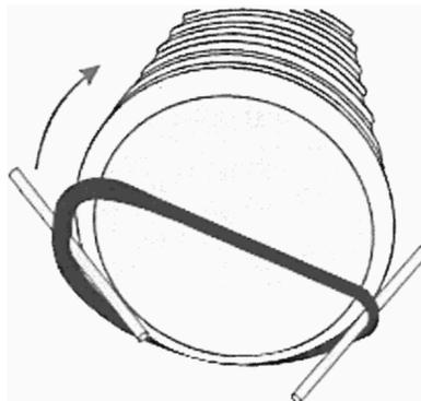
**Рисунок 10.8 - Установка уплотнительного кольца при помощи двух монтировок**
