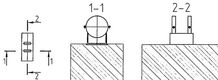
Рисунок 5.26 - Схема хомутовой опоры под трубопровод
