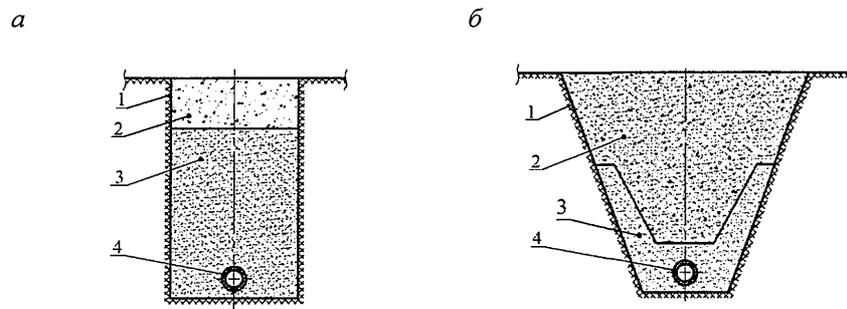
*а* - в траншее с вертикальными стенками; *б* - в траншее с откосами; 1 - контур траншеи; 2 - местный грунт; 3 - обратная засыпка траншеи разнозернистым песком; 4 - фильтр из геотекстиля
