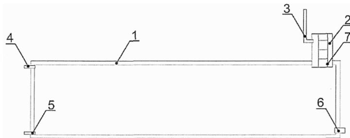
1 - корпус; 2 - шахта обслуживания; 3 - вентиляционная труба; 4 - подводящий патрубок; 5 - патрубок полного слива; 6 - отводящий патрубок; 7 - лестница
