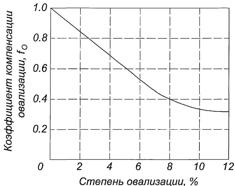
**Рисунок 5.27 - Определение коэффициента компенсации овализации**
