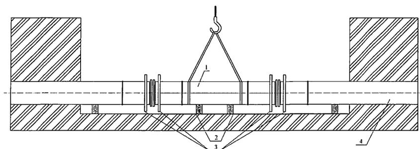
1 - трубная вставка; 2 - опора; 3 - фланец; 4 - трубопровод
