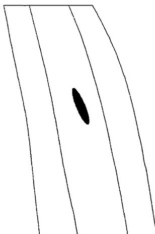
**Рисунок И.5 - Часть сварочного шва с раковиной**
