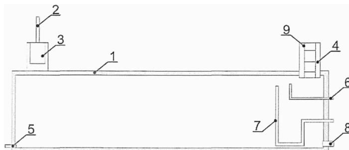
1 - корпус; 2 - вентиляционная труба; 3 - фильтр-поглотитель; 4 - шахта обслуживания; 5 - отводящий патрубок; 6 - подводящий патрубок; 7 - переливной патрубок; 8 - патрубок полного слива; 9 - лестница
