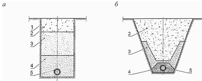
*а* - в траншее с вертикальными стенками; *б* - в траншее с откосами; 1 - контур траншеи; 2 - местный грунт; 3 - обратная засыпка траншеи разнозернистым песком; 4 - однослойная засыпка мелким щебнем; 5 - трубопровод
