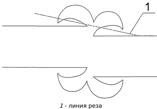
**Рисунок И.3 - Неравномерная форма грата при несовпадении кромок**
