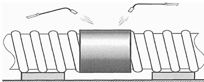
**Рисунок 6.3 - Усадка муфты с помощью двух горелок**
