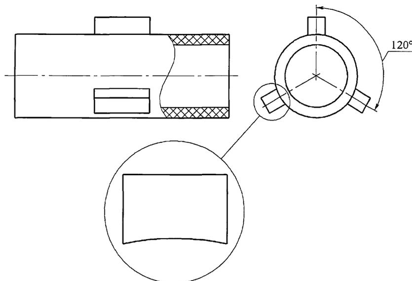
**Рисунок 5.24 - Общий вид установки наварных элементов**
