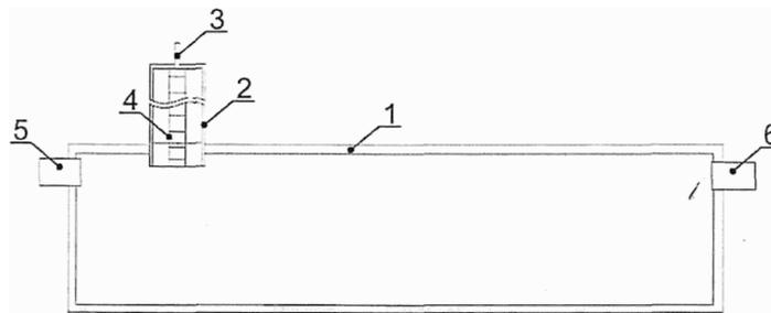
1 - корпус; 2 - шахта обслуживания; 3 - вентиляционная труба; 4 - лестница; 5 - подводящий патрубок; 6 - отводящий патрубок
