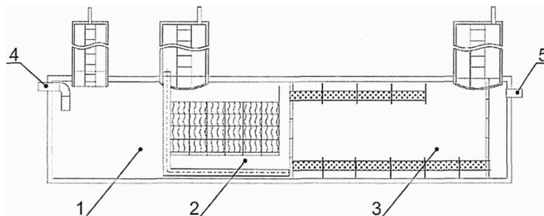
1 - пескоотделитель; 2 - маслобензоотделитель; 3 - сорбционный фильтр; 4 - подводящий патрубок; 5 - отводящий патрубок
