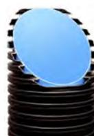
Трубы КОРСИС ПРО с увеличенным показателем кольцевой жесткости - 16 кН/м<sup>2</sup> (SN16) для производства работ в условиях городской инфраструктуры. Изготовлены из высокомолекулярного блок-сополимера полипропилена. Наружный цвет труб КОРСИС ПРО традиционного черного цвета с защитой от ультрафиолета, внутренний слой окрашен в светло-голубой цвет.
